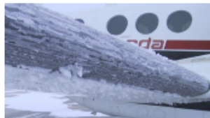
Figure 1 : Phénomène de givrage des bords d'attaque d'ailes d'avions.
