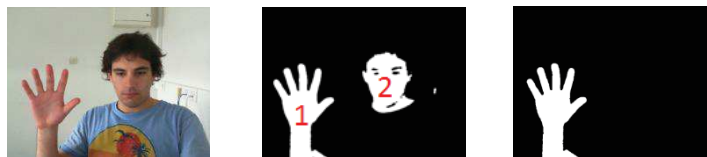
Figure 6. Etiquetage des zones. Les formes de la main sont conservées, même lorsque l'utilisateur déplace sa main avec moins d'amplitude. Le centre de gravité obtenu à l'étape de combinaison permet de connaître la zone en mouvement et de la couleur de la peau, ici numérotée « 1 » sur l'image du milieu.
