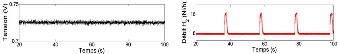
Figure 4. Tension et débit hydrogène pour un temps de fermeture de 20s et une durée de purge de 1s.
