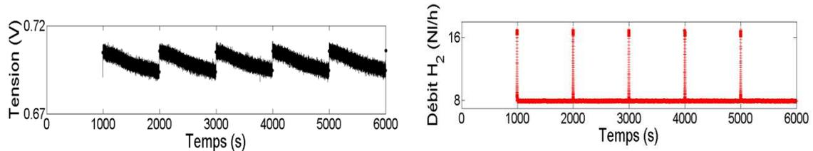
Figure 6. Tension et débit hydrogène pour un temps de fermeture de 1000s et une durée de purge de 1s
