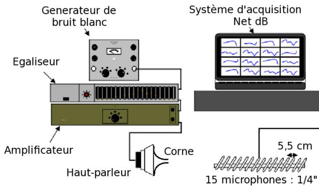
FIGURE 2 – Chaîne de mesure.
