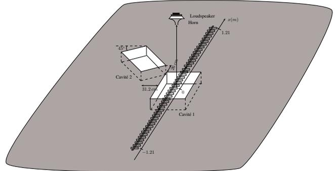
FIGURE 3 – Positions juxtaposées de l'antenne de 15 microphones
