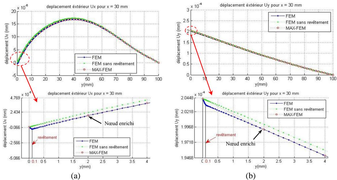
Figure 5. La distribution des champs de déplacements dans la section  $x = 30\text{ mm}$ .
