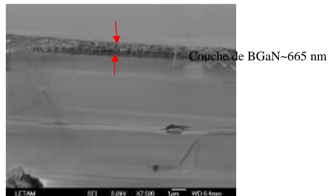
Figure 4: Vue sur la tranche de B x GaN/AlN; épaisseur estimée ~665nm
