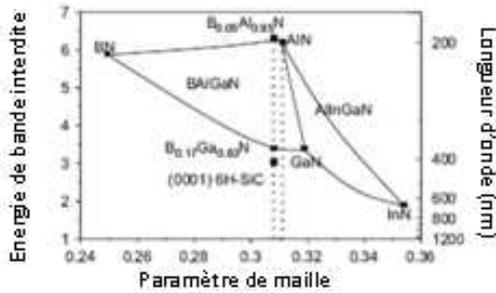
Figure 1 : Diagramme de l'énergie interdite en fonction du paramètre de maille pour les alliages BAlGaIn
