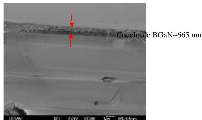
Figure 4: Vue sur la tranche de B<sub>x</sub>Ga<sub>1-x</sub>N; épaisseur estimée ~665nm
