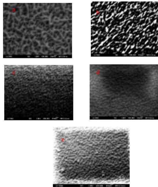
Figure 3: Images MEB des échantillons de B<sub>x</sub>Ga<sub>1-x</sub>N avec différentes compositions de bore
