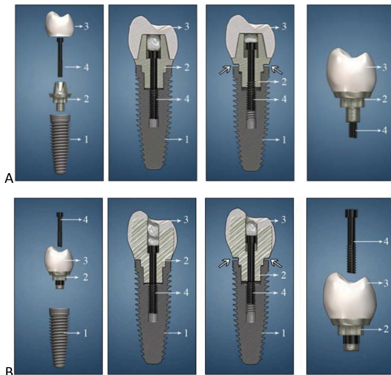
Figure 39 : Restauration prothétique scellée sur le pilier transvissé (A) / Restauration prothétique transvissée (B) (1 : implant ; 2 : pilier ; 3 : Restauration prothétique ; 4 : vis permettant de transvisser le pilier (A) ou la restauration prothétique dans sa globalité (B)) (issu de (107)).
