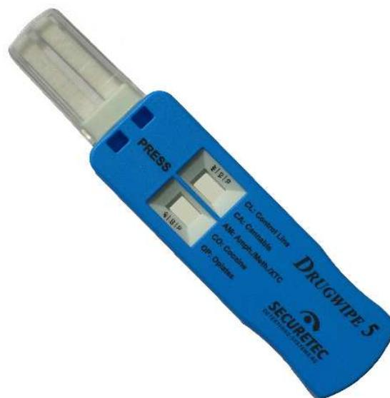
Figure 10 : Test Drugwipe<sup>®</sup> pour la détection de substances psychoactives dans la salive ou la sueur (45)
