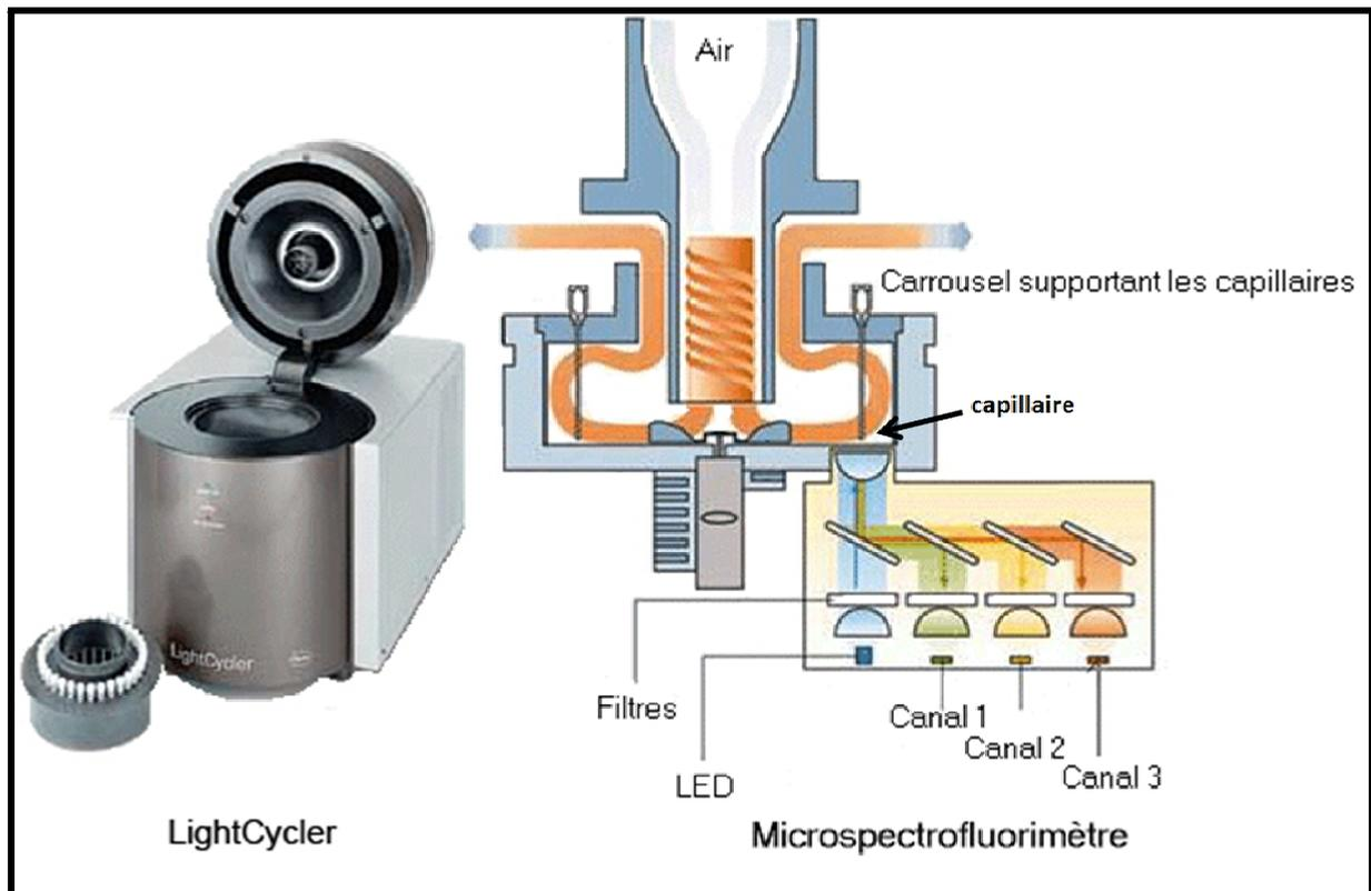
*Figure 29* : Photographie du LightCycler® v1.2 et sa représentation schématique
