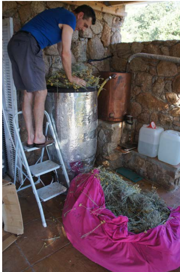
Figure 23 Distillation immédiate après la récolte
