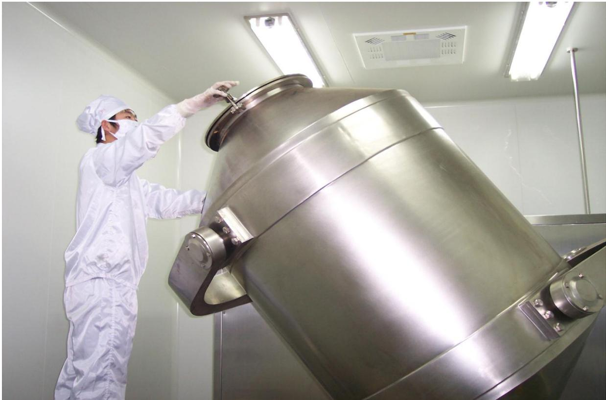
Figure 35 : Cuve pour décoction.
