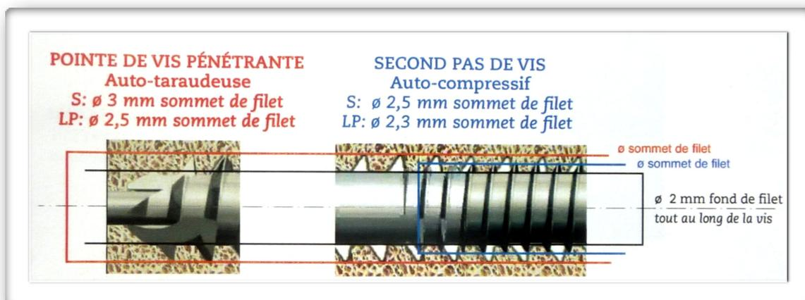
Figure 40 : Fonctionnement de la vis AREX Scru 2
