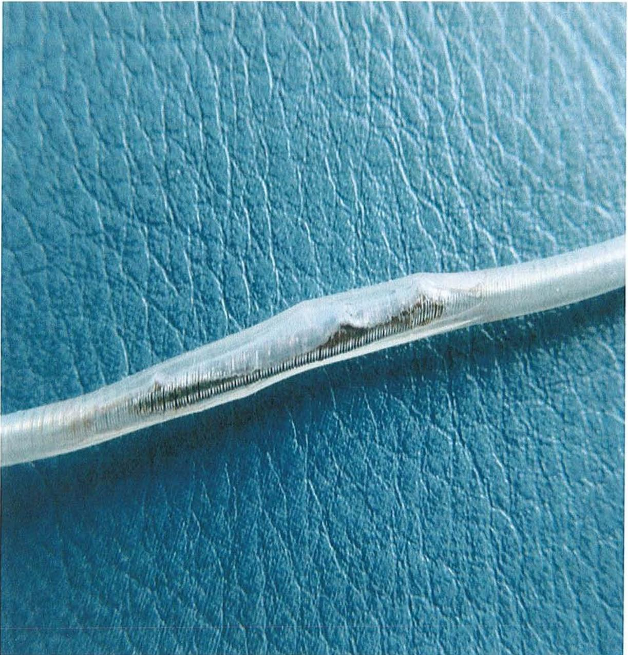
**Figure 20 : Rupture d'isolant d'une sonde de défibrillation par abrasion au contact du boîtier pectoral à l'origine de bruit chez un patient nancéien**
