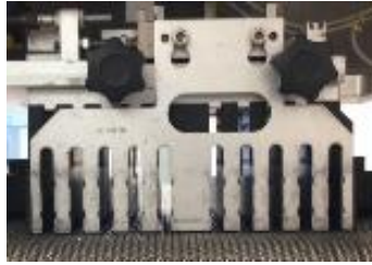
Figure 9 : Illustration de l'élément nommé « Grilles » sur la machine de mise en boîte
