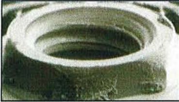
Fig 14b : scanner d'un implant à hexagone externe ayant reçu un pilier en céramique (CerAdapt®). Les coins de l'hexagone sont arrondis et la partie supérieure de l'hexagone a également été altérée, elle est arrondie. Des débris de titane, abrasés par le pilier en céramique, sont visibles. (d'après 19)
