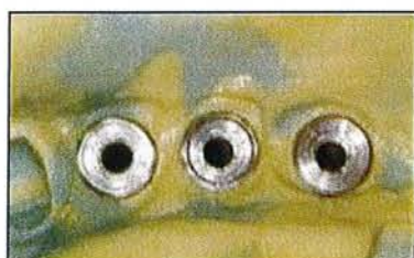
Fig 2i : les transferts sont emprisonnés au sein du matériau.
