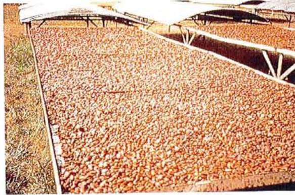
Figure n° 19 : Séchage solaire sur claies avec toit mobile
