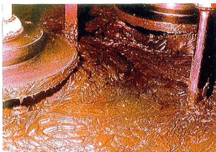
Figure n° 22 : Un conchage prolongé transforme la pâte grumeleuse en un chocolat velouté et très onctueux
