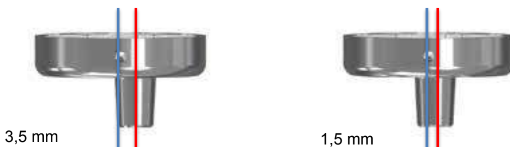
Figure 11 : Platines inversées excentrées : grande excentration 3,5 mm ou petite excentration 1,5 mm
