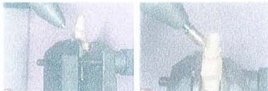
Figure 17 : Palpeur en place contre le die.
