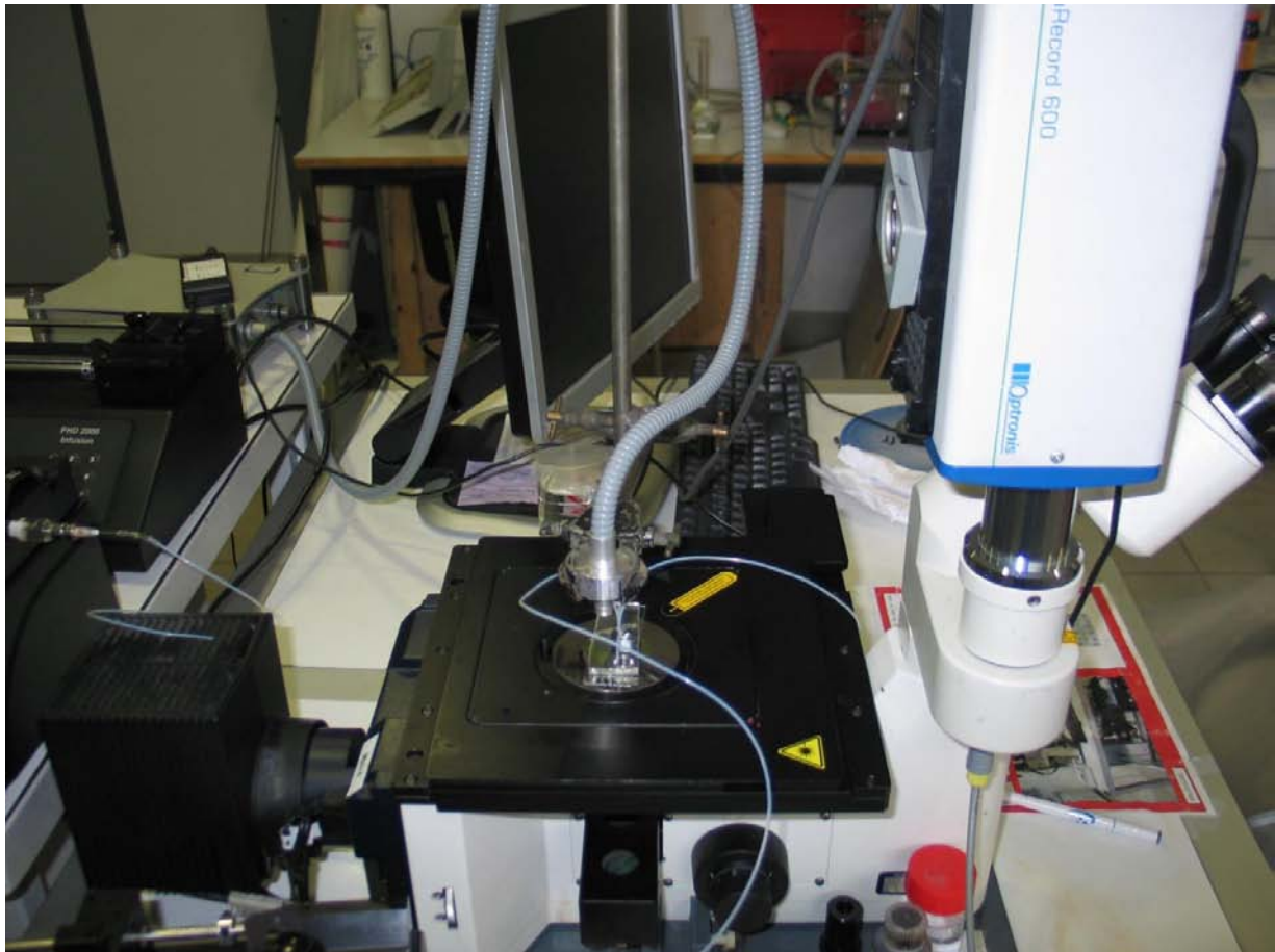
Figure 41 : Fabrication des émulsions doubles
