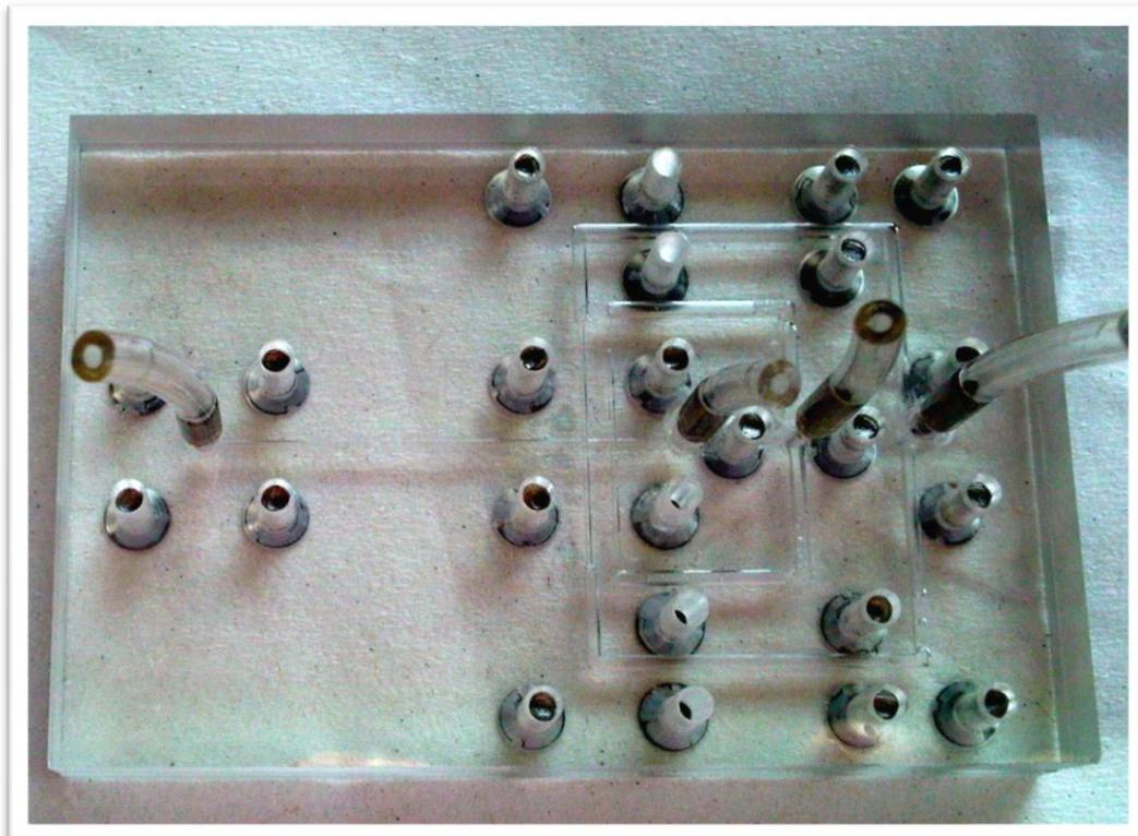
Figure 27 : Microsystème en polycarbonate et plexiglas<sup>®</sup>
