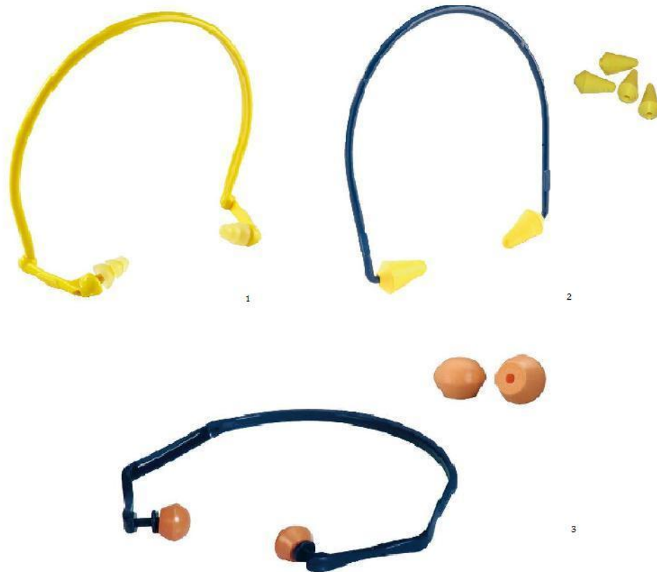
Figure 38 : Bouchons à arceau . 1. Bouchons en matière plastique souple réutilisables avec arceau à plusieurs positions ; 2. Bouchons coniques en mousse jetables et arceau fixe ; 3. Bouchons arrondis en mousse jetables et arceau flexible (70)
