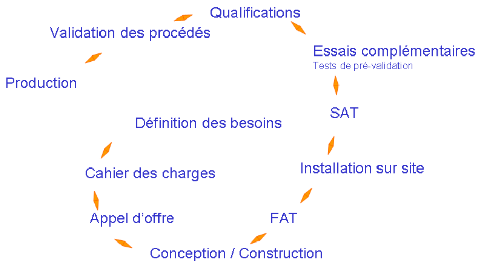
Figure 15 : Etapes de la qualification des équipements
