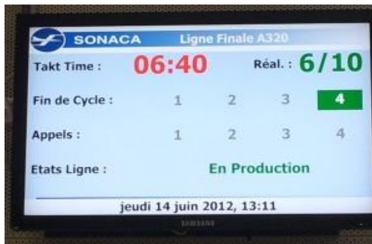
Figure 21: Exemple de tableau Andon (d'après www.dpc-engineering.com )
