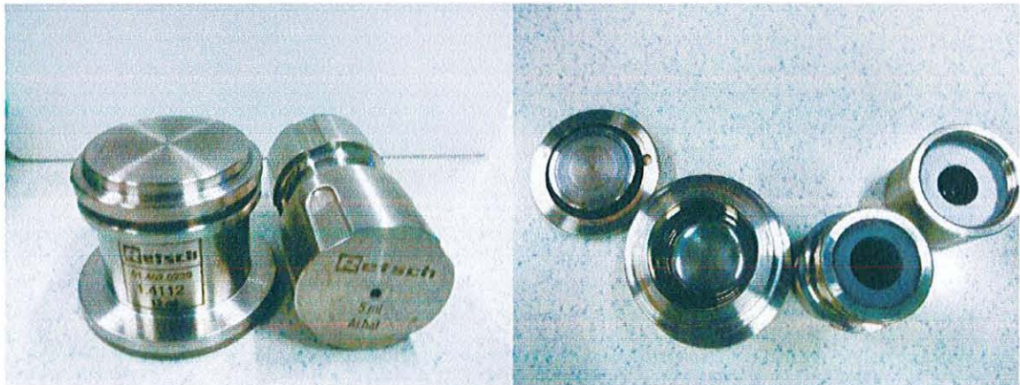
Figure 26 : Différents types de conteneurs utilisés (en acier inoxydable ou revêtu d'agate) dans l'étude
