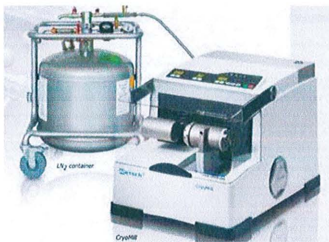
Figure 24 : Broyeur à vibrations Cryomill® (70)
