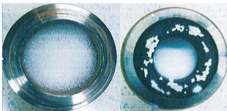
Figure 33 : Préparation d'une nanosuspension du composé A par le procédé de broyage à vibrations. Photo à gauche : préparation sans additif anti-moussant; à droite : préparation avec additif anti-moussant
