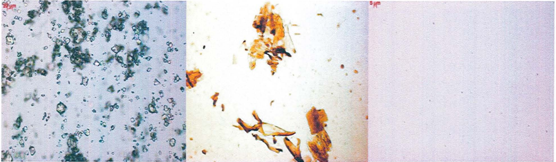
Figure 45 : Photos de gauche à droite : Suspension de A à l'état initial cristallin; Suspension amorphe obtenue par solubilisation-précipitation du composé A; 10ml de suspension après 90' de sonication
