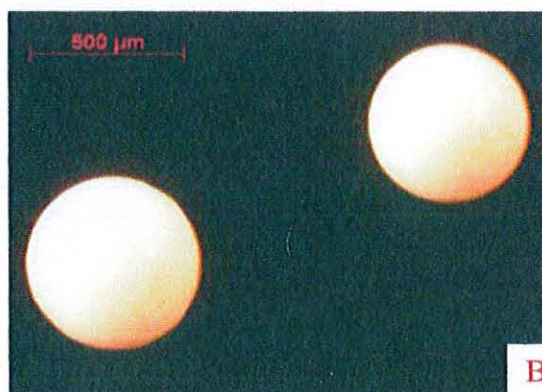
Figure 25 : Photo A : de gauche à droite, bille de ZrO 2 de 1cm de diamètre, bille en acier inoxydable de 2mm de diamètre, bille en ZrO 2 de 0,5 mm de diamètre. (grossissement 100x) Photo B : bille en ZrO 2 de 0,5 mm de diamètre
