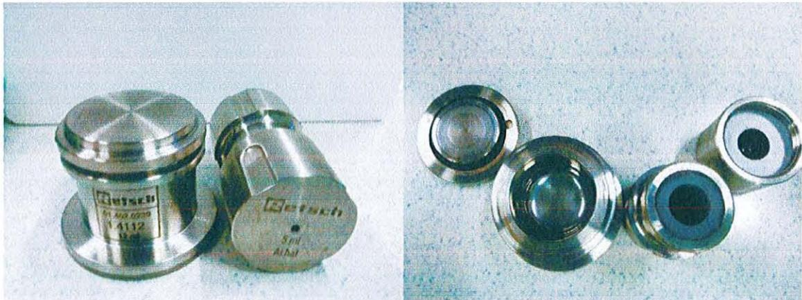
Figure 26 : Différents types de conteneurs utilisés (en acier inoxydable ou revêtu d'agate) dans l'étude
