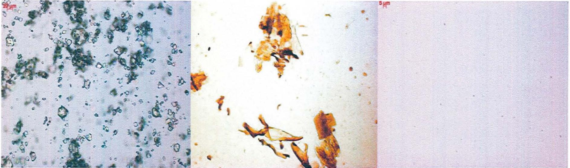
Figure 45 : Photos de gauche à droite : Suspension de A à l'état initial cristallin; Suspension amorphe obtenue par solubilisation-précipitation du composé A; 10ml de suspension après 90' de sonication
