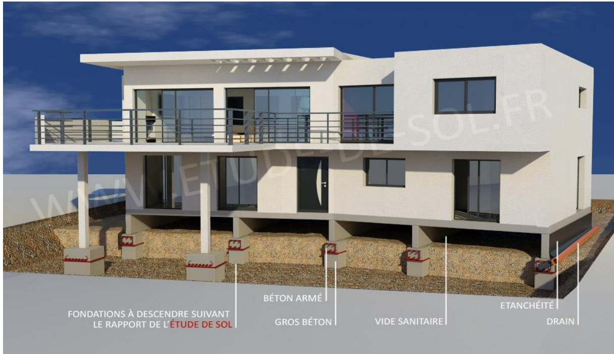
Figure 3 : Principe de fondations suivant un rapport d'étude de sol (source : www.etude-de-sol.fr )
