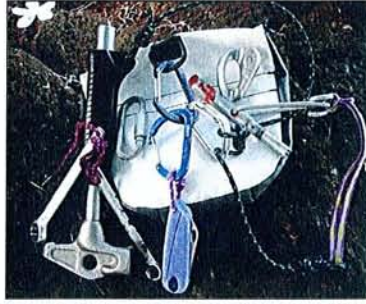
Photo 16 : tamponnoir, marteau, couteau, clé et trousse à Spits.
