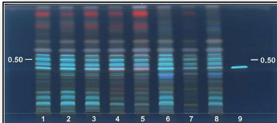
**Figure 38 : Chromatogramme obtenu à partir de la poudre d'*H. gordonii* correspondant au dépôt 1 et celui du P57 (dépôt 9). Les autres dépôts correspondent à des produits commercialisés et contenant de l'*Hoodia*, d'après [16]**
