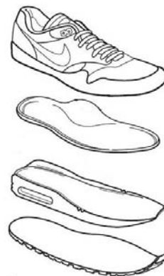
Figure 82 : Du haut en bas, la tige, la semelle interne, la semelle intermédiaire et la semelle externe de la chaussure [50]
