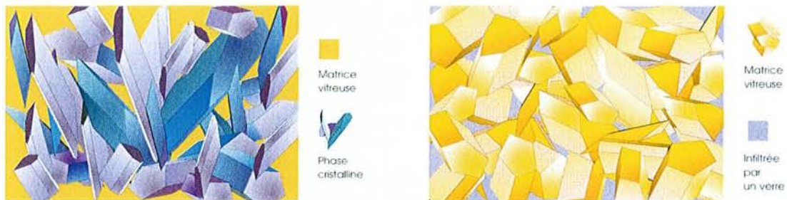
Microstructure d'une vitrocéramique [53] Microstructure d'une céramique In Ceram [53]
