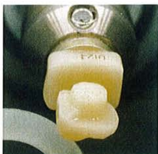
Usinage d'un Vitabloc MKII® dans une machine Cerec 3® pour la réalisation d'une endocouronne [63]
