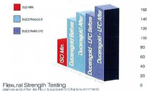
Après 48 heures d'exposition dans la cavité buccale, les céramiques hydrothermales deviennent plus résistantes (document du fabricant)
