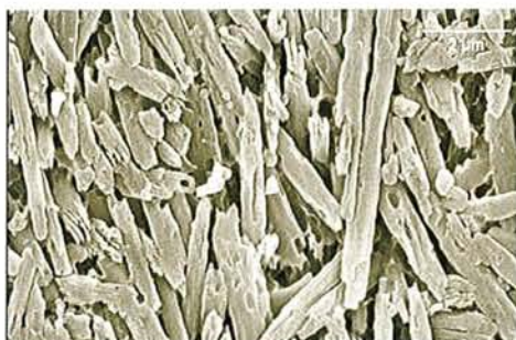
Céramique e.max Press® après 30 secondes de mordantage à l'acide fluorhydrique laissant apparaître les cristaux de disilicate de lithium (document Ivoclar-Vivadent)
