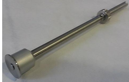
Figure III.50 : Pistons de compression et les têtes de cisaillement du rhéomètre FT4 pour la mesure d'angle de friction à la paroi
