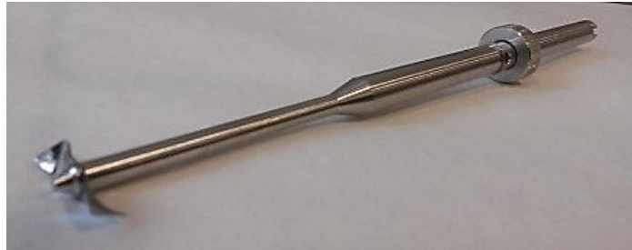
Figure III.39 : Mobile de mesure du rhéomètre FT4 pour la mesure de l'énergie d'écoulement
