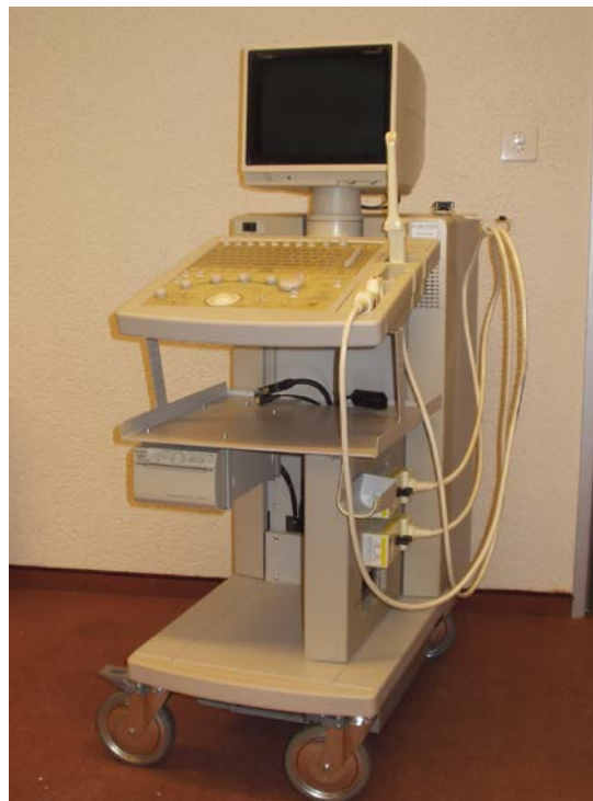
Figure 12 : Photo d'un exemple d'échographe dit conventionnel (ici EUB 525 HITACHI) pesant 145kg et mesurant 51cm de large, 87cm de profondeur et 140cm de hauteur (données constructeur).
