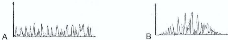
Figure 30 : Laser pulsé : A : à niveau constant, B : à enveloppe impulsionnelle.
