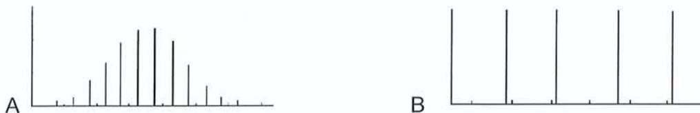
Figure 32 : Laser à synchronisation de mode : l'enveloppe d'impulsion est elle-même une impulsion (A) ou une constante (B).
