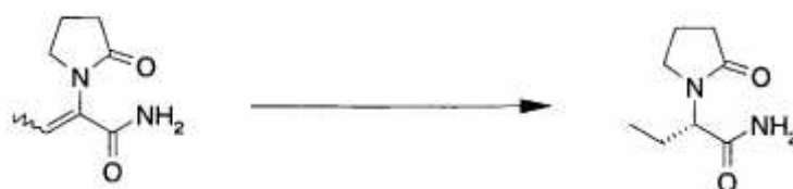
Figure 22 : Procédé de fabrication industrielle du Levetiracetam par hydrogénation asymétrique
