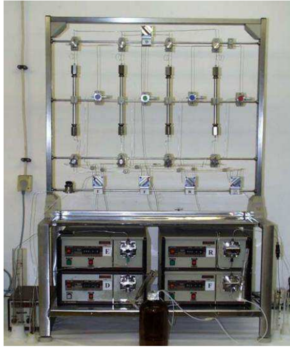
Figure 36 : Photographie d'un système de lit mobile simulé de laboratoire à 4 colonnes chromatographiques
