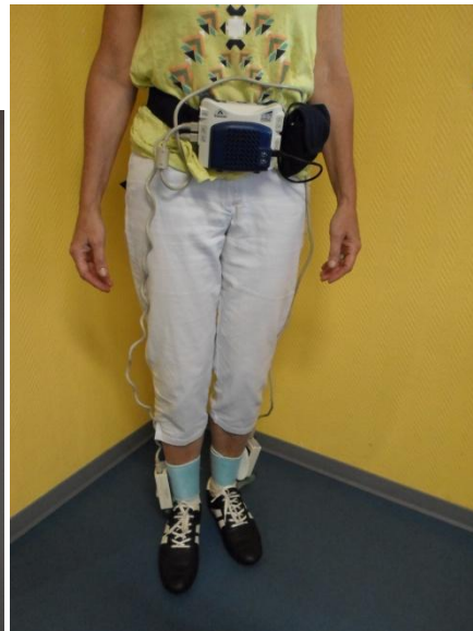
Figure 1 : Dispositif matériel du système F-scan®. Semelles embarquées comportant des capteurs résistifs, boîtiers d'interface fixés aux chevilles, boîtier d'acquisition relié à la ceinture
