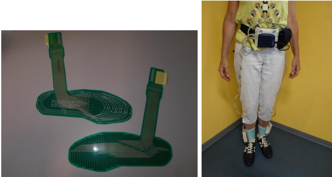
Figure 1: Dispositif matériel du système F-Scan® : semelles embarquées comportant des capteurs résistifs, boîtiers d'interface fixés aux chevilles, boîtier d'acquisition relié à la ceinture
