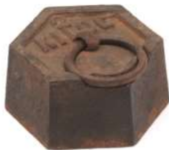
Figure 66 : Etalon hexagonal de kg muni d'un anneau.
