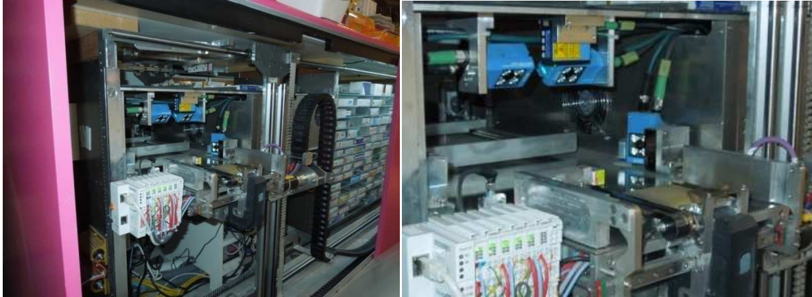
Figure 31 : Photos des lecteurs datamatrix® et la tête du robot comptoir Sellen
