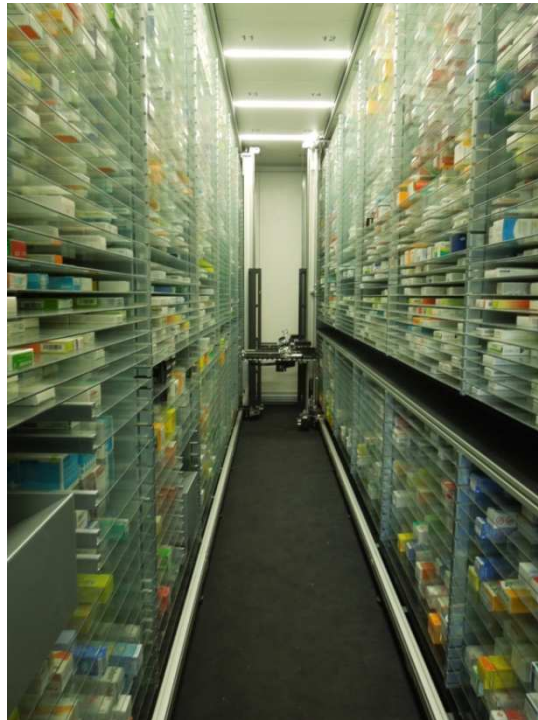
Figure 21 : Photo des armoires et des deux bras robotisés du Rowa Vmax
