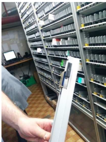
Figure 11 : Photo du canal de rangement de l'automate Pharmax
