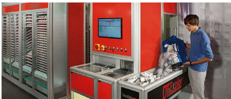
Figure 27 : Deuxième méthode de remplissage du DreamTech [27]
