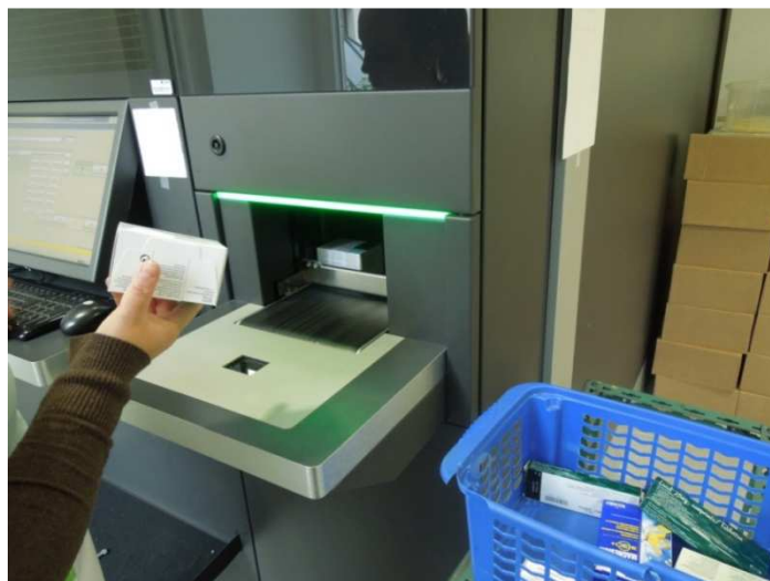
Figure 20 : Photo du poste de commande du Rowa Vmax
