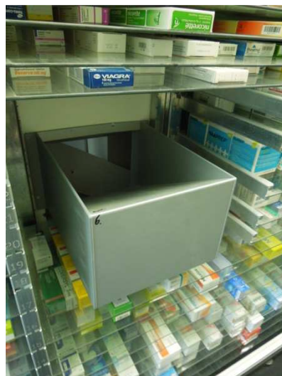
Figure 22 : Photo d'une gare vers le système de convoyage
