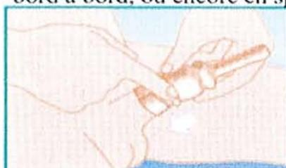
**4** On déroule soigneusement l'étui jusque sur le joint de fixation, puis on serre les deux parties en contact de manière à obtenir une bonne adhésion.
