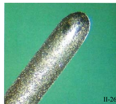
Figure II-26 : Usure extrême d’une fraise diamantée présentant une zone totalement lisse dépourvue de diamants. (173)
