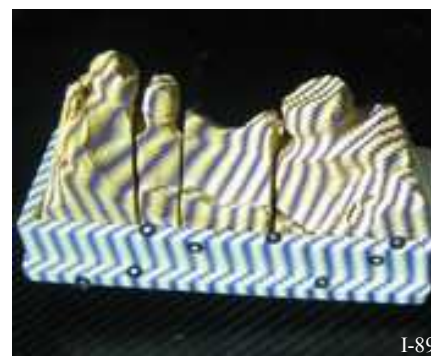
Figure I-89 : Technique d'acquisition numérique par grille projetée (phénomène de moiré). (200)
