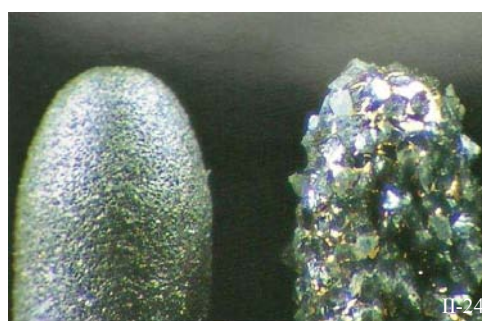
Figure II-24 : À gauche : Fraise diamantée à grains fins. À droite : fraise diamantée à gros grains (sous microscope x20). (173)
