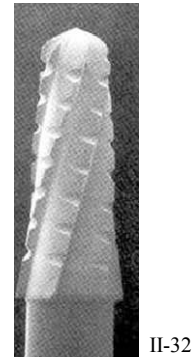
Figure II-32 : Fraise surtaillée en carbure de tungstène. (11)
