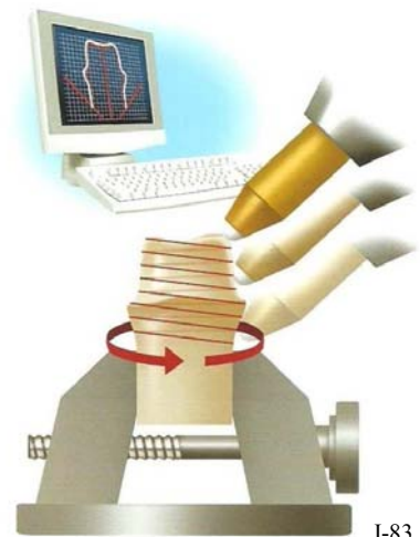
Figure I-83 : Procédé d'acquisition numérique par micro-palpation. (29)
