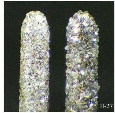
Figure II-27 : Une fraise usée (à gauche) et une fraise neuve (à droite). (173)
