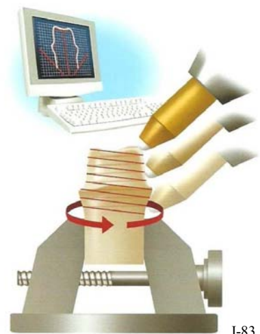
Figure I-83 : Procédé d'acquisition numérique par micro-palpation. (29)
