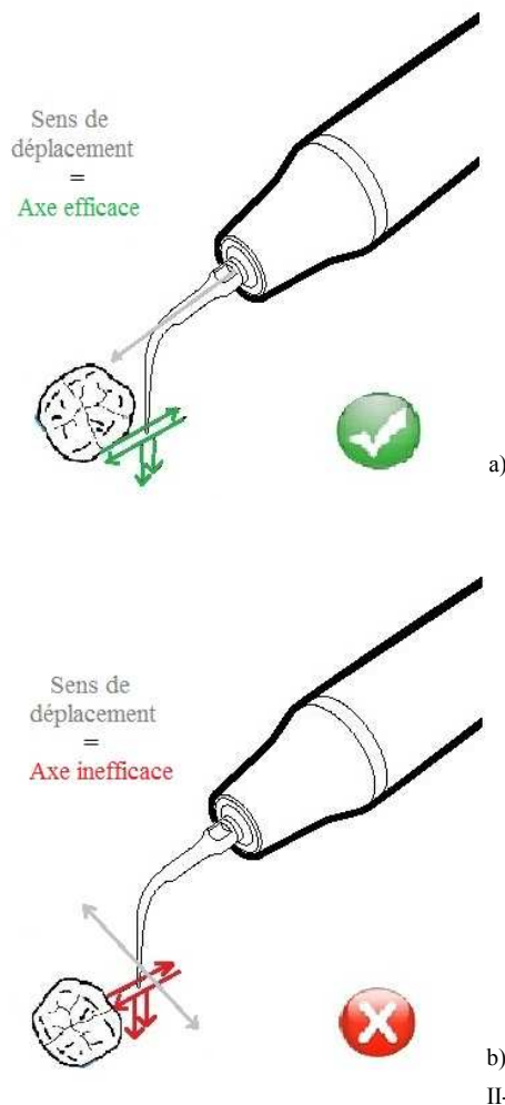
Figure II-7 : a) Les inserts US doivent fonctionner selon une orientation précise pour être efficaces : celle de l'axe de la pièce à main (axe efficace). Le sens de déplacement de l'instrument doit être confondu avec l'axe de vibration de la pointe de l'insert. b) Sinon leur effet est quasi nul. (D'après (f))
