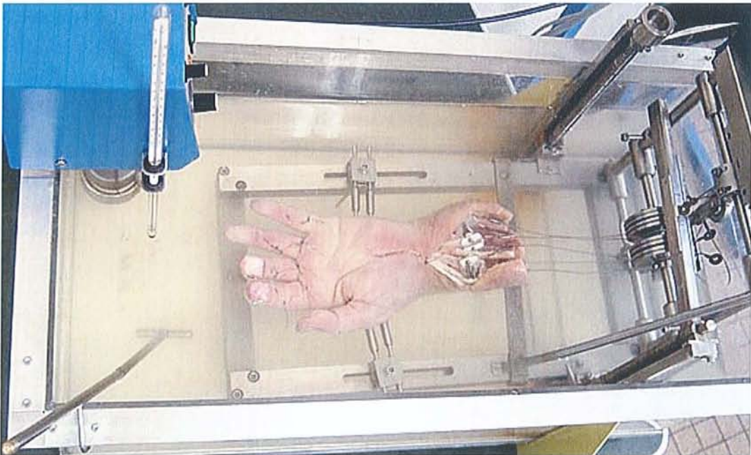
Le cadre est plongé au fond de la cuve dans le sérum physiologique chauffé à 37°C.
