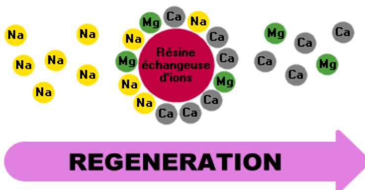
Figure 16 : Principe de régénération des résines échangeuses d'ions
