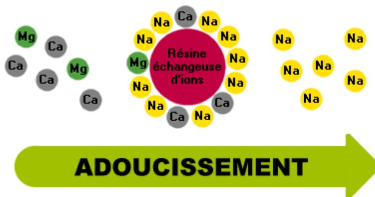
Figure 15 : Principe de l'adoucissement de l'eau
