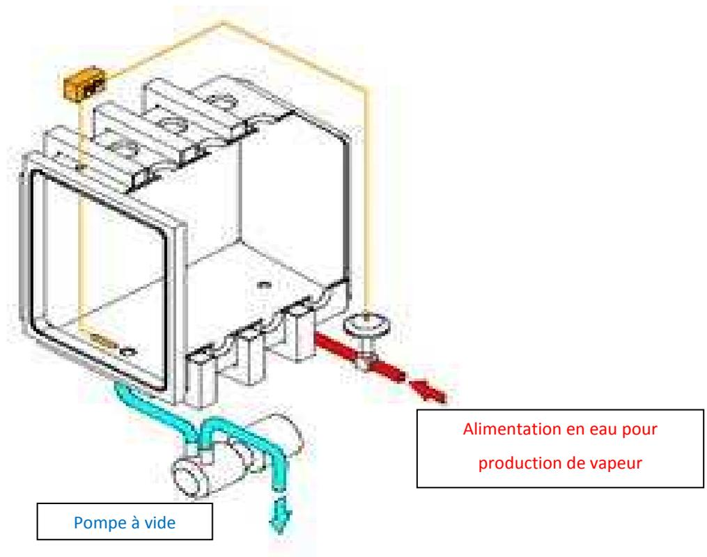
Figure 18 : Schéma des flux hydrauliques d'un autoclave
