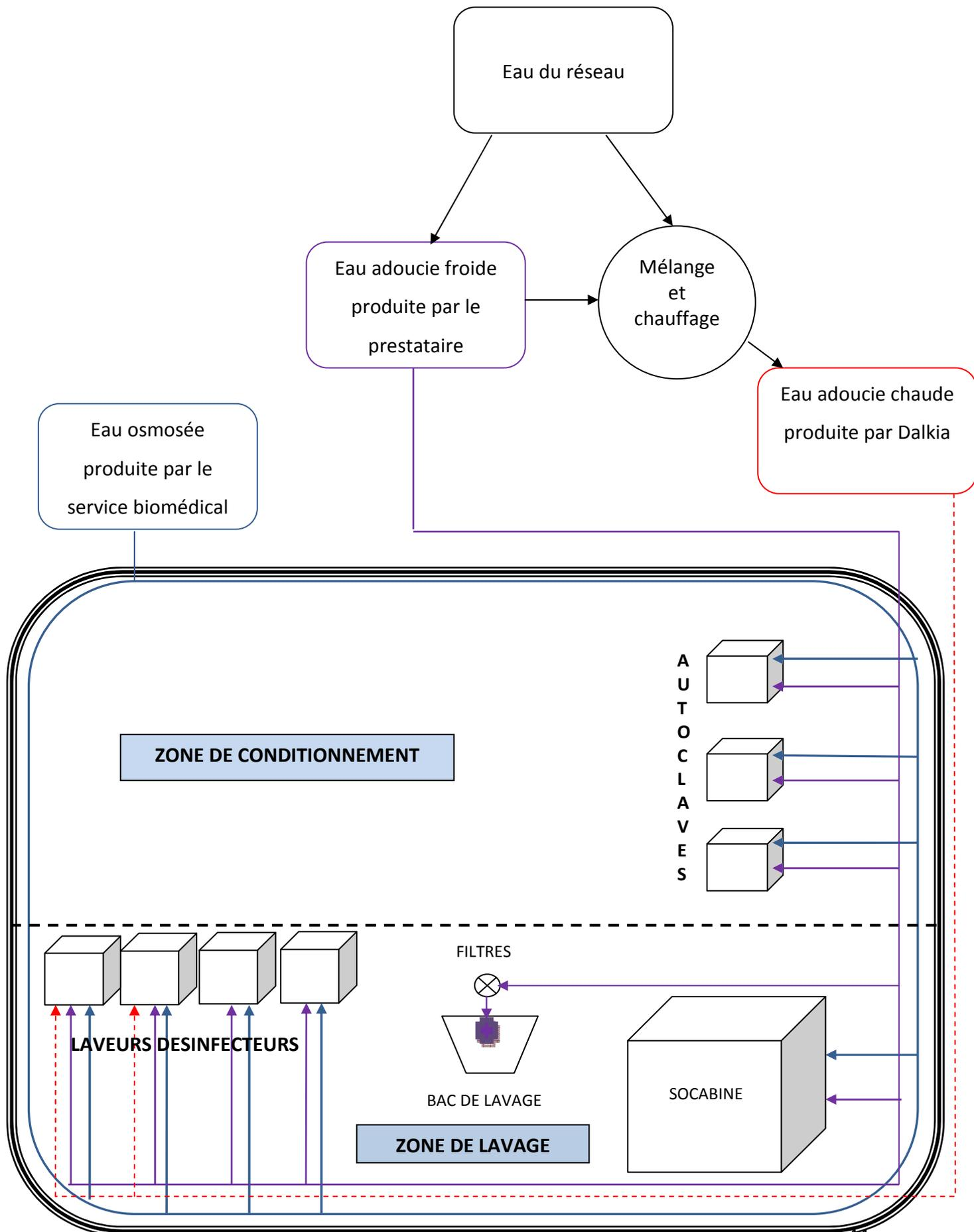
Figure 27 : Schéma des circuits d'eau alimentant la stérilisation
