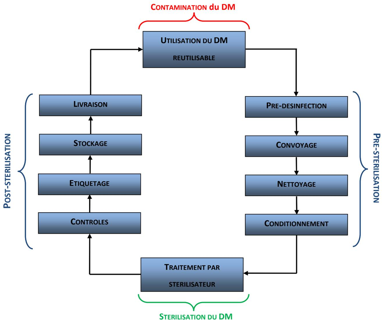
Figure 1 : Schéma de la chaîne de stérilisation
