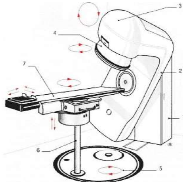
Figure 8 : schéma d'un accélérateur de particules utilisé en radiothérapie (37). Le canon à électron (3) est relié au bras (2) pouvant tourner autour d'un statif (1). Le faisceau d'électron est modelé grâce à un collimateur (4). Le patient est allongé sur une table (7) qui repose sur un plateau rotatif (5).
