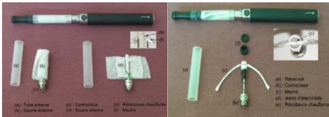
Figure 7 : Anatomie d'un cartomiseur Figure 8 : Anatomie d'un clearomiseur (source des photos 2 et 3 : Forum des utilisateurs de cigarette électronique, 2012).
