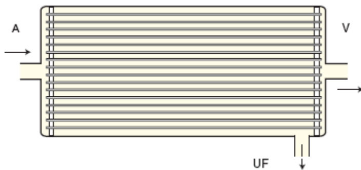
Figure 3: Architecture d'un filtre capillaire en hémofiltration
